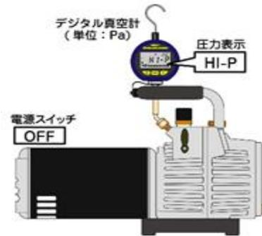
図 D.1 真空ポンプの大気圧表示
