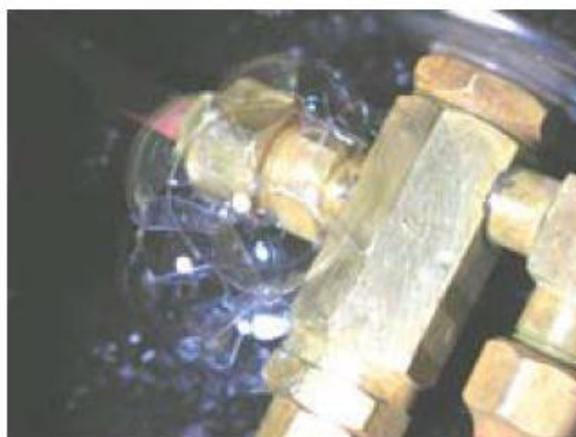
図 B.12 発泡液法による検知例(3)
