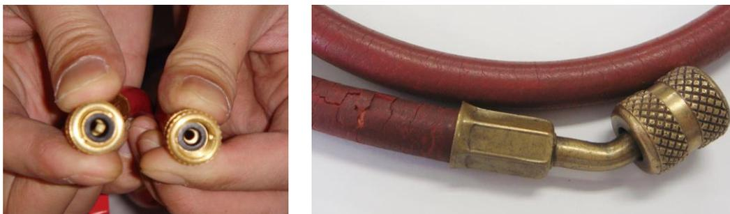
図 C.6 チャージングホースの劣化例 (Oリング, ひび割れ)
