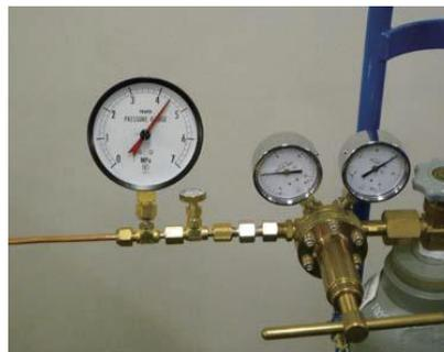
図 C.2 加圧試験器具の接続
