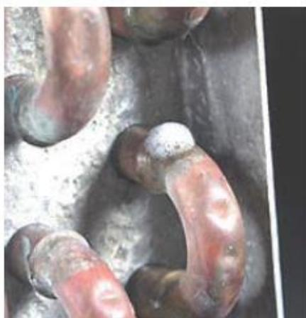
図 B.11 発泡液法による検知例(2)
