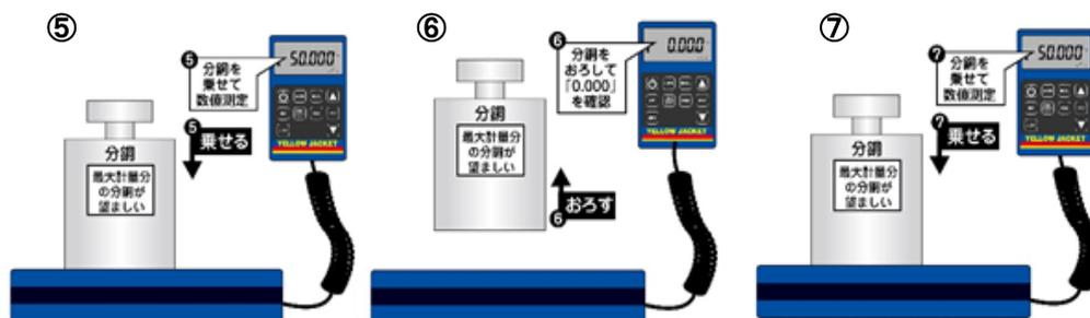
図 E.2 デジタルスケールの秤量付近再現性点検
