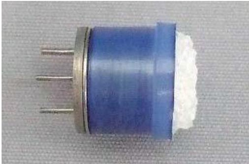
図 B.1 半導体センサの例
